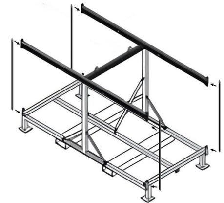
Des trous sont placés aux extrémités de chaque barre ainsi que sur les platines du rack. Fixez les éléments avec les boulons que vous trouverez dans la visserie du rack de stockage.
